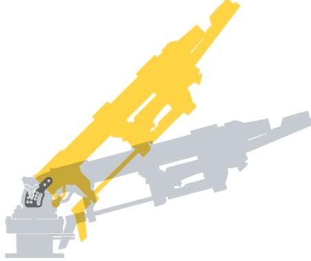
Der Strahlwinkel ist zwischen 15° und 45° manuell verstellbar. L'angolo di traiettoria è regolabile manualmente e può variare tra i 15° e i 45°.
