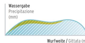
Schematisches Profil der Wasserverteilung **mit** dynamischen Strahlstörer. Profilo schematico di distribuzione dell'acqua **con** spartiacqua.
