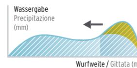
Schematisches Profil der Wasserverteilung **ohne** dynamischen Strahlstörer. Profilo schematico di distribuzione dell'acqua **senza** spartiacqua.
