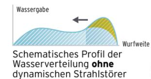
Schematisches Profil der Wasserverteilung ohne dynamischen Strahlstörer
