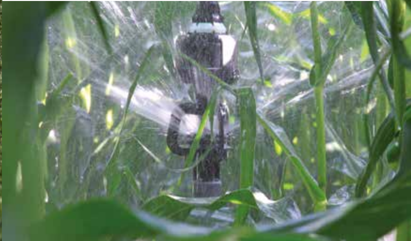
Corn in canopy / Dosel de maíz - 10psi - KPT Standard Trajectory Angle
