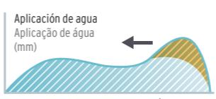
Perfil esquemático de la distribución del agua **sin** rompe-chorro dinámico
