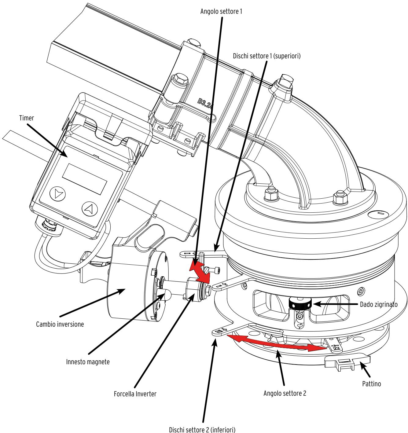
Il Komet Inverter (brevetto Komet) consente all'irrigatore di operare in due angoli settore indipendenti. L'irrigatore inizia ad irrigare nell'angolo settore 1 e passa automaticamente all'angolo settore 2 dopo il trascorrere di un tempo preimpostato.
