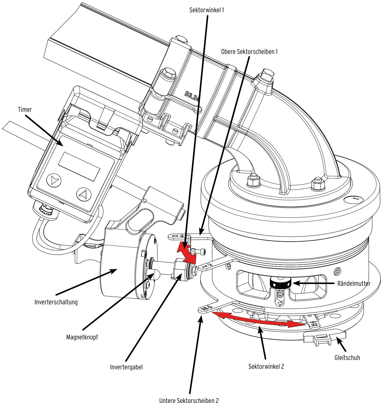
Der patentierte Komet Inverter erlaubt es, den Regner in zwei voneinander unabhängigen Sektoren arbeiten zu lassen. Der Regner startet im Sektorwinkel 1 und wechselt nach Ablauf einer mittels Timer voreingestellten Zeit automatisch in den Sektorwinkel 2.
