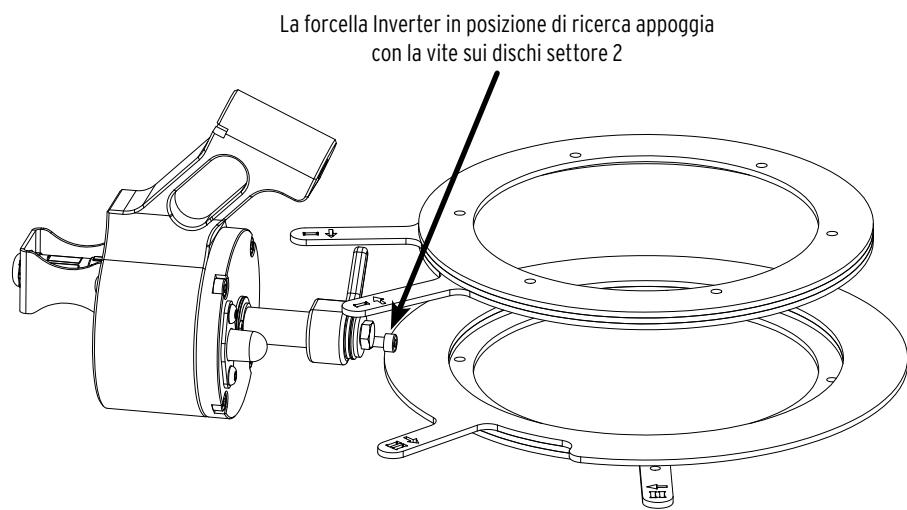
La forcella Inverter scivola sui dischi settore inferiore 2 fino a quando trova l'apertura attraverso la quale cadrà in **posizione bassa**. La forcella Inverter viene bloccata nella posizione bassa. L'irrigatore ora continua a funzionare nell'angolo settore 2.
