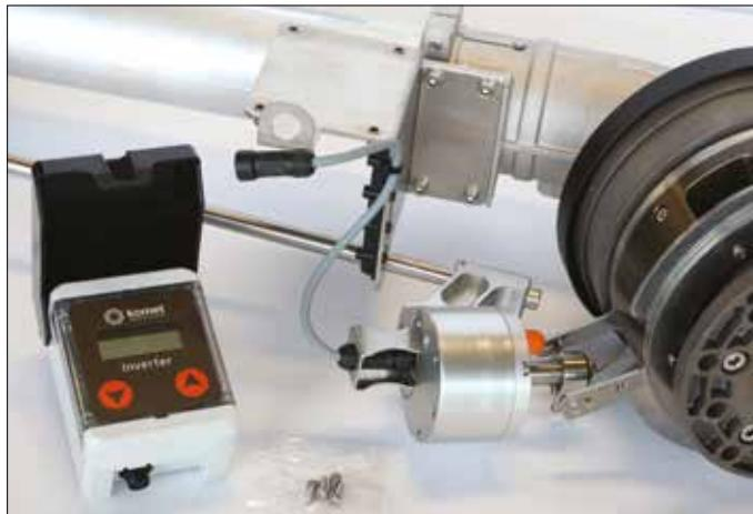
Appoggiare l'irrigatore sul fianco in modo che la staffa di montaggio del timer sia rivolta verso l'alto.
