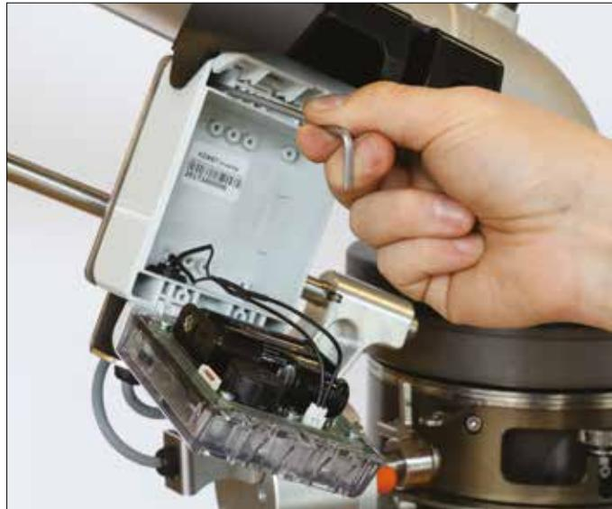
Monter le compteur à l'aide des quatre vis Allen fournies (M4x12). La prise doit être tournée vers le bas.
