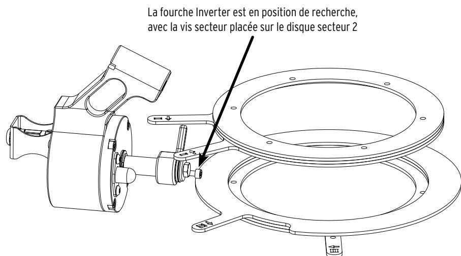
La fourche Inverter se déplace alors en mode recherche le long des disques secteurs inférieurs, jusqu'à ce qu'elle tombe dans l'encoche et se mette en **position basse**, afin de continuer de fonctionner en secteur 2.
