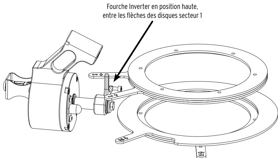
Après le décompte du compteur, un aimant se détache, va déverrouiller la fourche Inverter et la mettre en **mode recherche**.
