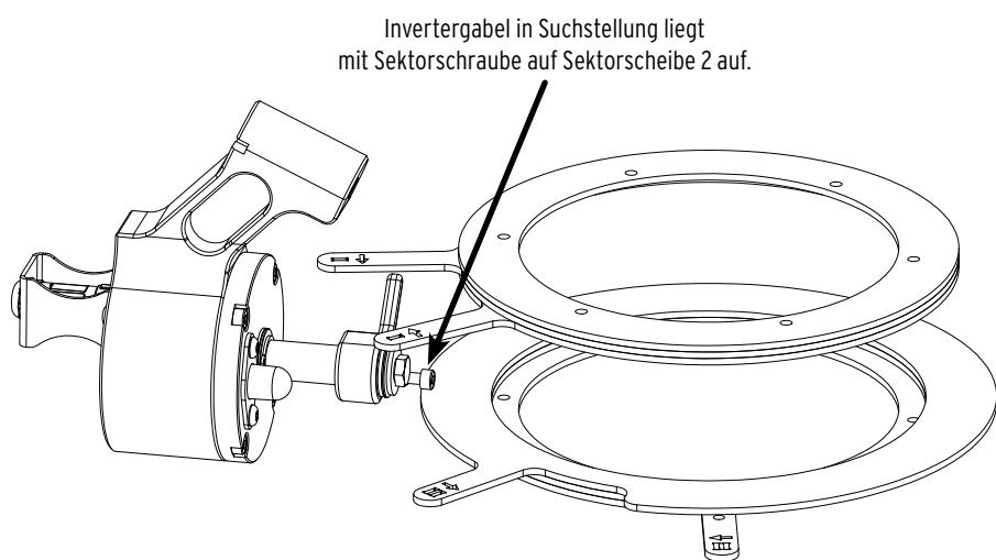
Die Invertergabel fährt nun in Suchstellung auf den unteren Sektorscheiben entlang, bis sie durch die Aussparung fällt, in **Position Unten** einrastet, und im Sektor 2 weiterarbeitet.
