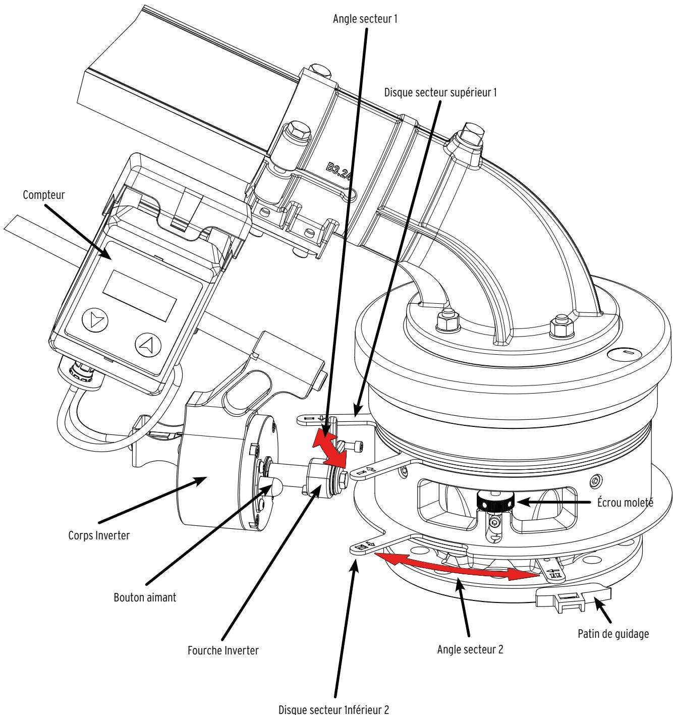
L'Inverter Komet breveté permet à l'arroseur de fonctionner dans deux secteurs indépendants l'un de l'autre. L'arroseur commence son travail dans l'angle secteur 1 et après que la durée impartie à l'aide du compteur est écoulée, se tourne automatiquement vers l'angle secteur 2.
