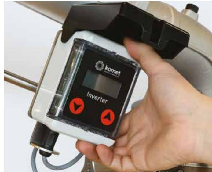
Riposizionare il coperchio e bloccarlo accuratamente con i ganci per evitare infiltrazioni d'acqua nel timer.
