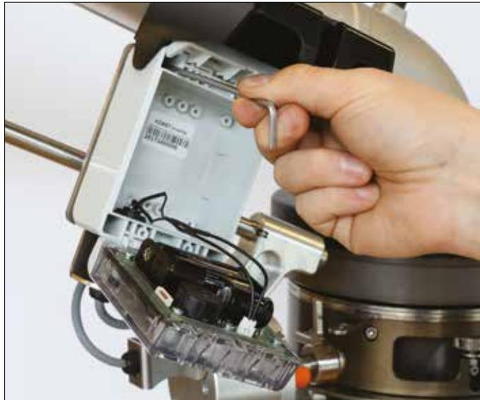
Fissare il timer con le 4 viti testa cava esagonale (M4x12). Assicurarsi che il connettore sia rivolto verso il basso.
