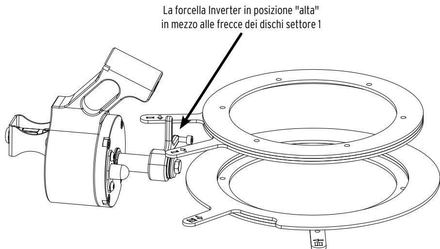
Dopo lo scadere del timer, viene attivato un magnete che libera la forcella Inverter in modo da potere essere portata in **posizione di ricerca**.
