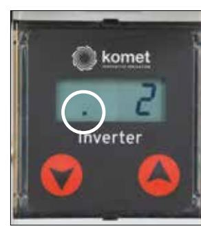
**ATTENZIONE! L'accelerometro è molto sensibile.** Anche oscillazioni del carrello portairrigatore, per esempio saltando dal carrello portairrigatore dopo avere attivato il timer, possono innescare il conto alla rovescia. Prima di allontanarsi dall'irrigatore, assicurarsi che il timer sia attivato, però non abbia ancora iniziato il conto alla rovescia.
