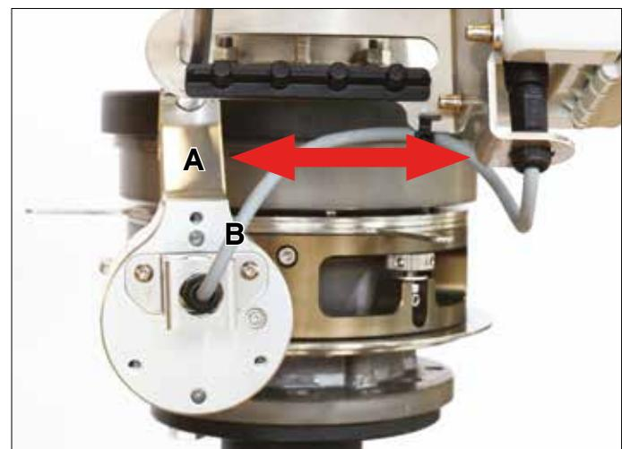
Muovere l'asta settore da sinistra a destra (A) e verificare che il cavo (B) non sia sotto tensione.
