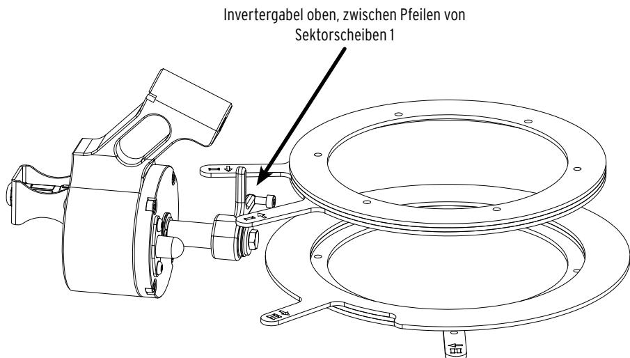
Nach Ablauf des Timers, wird ein Magnet gelöst, welcher die Invertergabel löst und in **Suchstellung** bringt.
