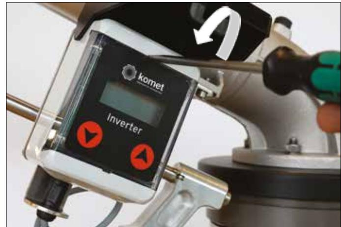
Sbloccare il coperchio del timer inserendo un cacciavite nelle apposite fessure. **RUOTARE** il cacciavite per sbloccare il coperchio.
